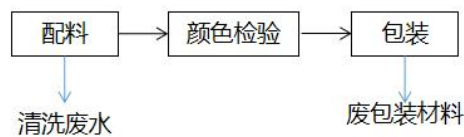
图 2-7 染色液/染色剂调配工艺流程及产污节点图
