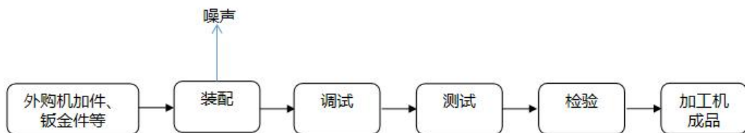
图 2-16 牙冠加工机工艺流程及产污节点图
